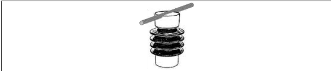
Figuur 5.39. Plaatsingswijzen van elektrische leidingen – Op isolatoren
